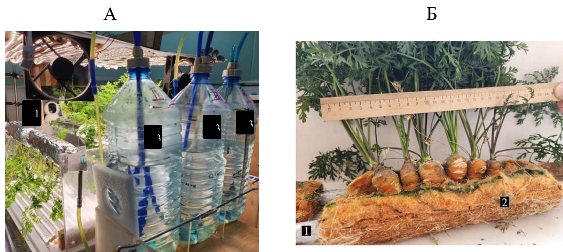
Рисунок 1 – Вегетационный стенд с растениями моркови в возрасте 22 суток (А) и корнеплоды моркови на 60-е сутки вегетации в волокнистом почвозаменителе БИОНА – ВЗ (Б). 1 – пористая титановая трубка; 2 – волокнистый почвозаменитель; 3 – сосуды Мариотта с питательным раствором
