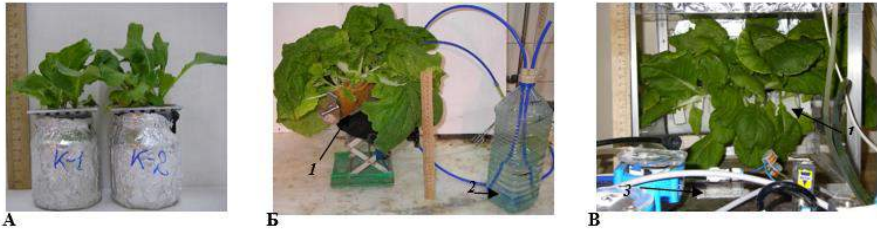
Рисунок 1 - Выращивание растений китайской капусты в водной культуре (А) и в корневых модулях космической оранжереи «Витацикл-Т», соединенных с сосудом Мариотта (Б) или регулятором режима увлажнения (В). 1 – корневые модули оранжереи, 2 – сосуд Мариотта, 3 – регулятор режима увлажнения
