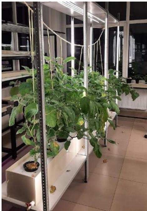
Рисунок 2 – Аэропонная установка с баклажанами
