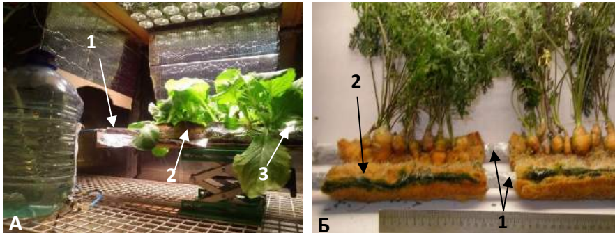
Рисунок 2 – Корневой модуль с цилиндрической мелкопористой мембраной с посевом китайской капусты (А) и моркови (Б). 1 – пористые трубки из мелкопористого титана, 2 – вкладыши из волокнистого ионообменного соленасыщенного почвозаменителя БИОНА-ВЗ, 3 – защитный чехол
